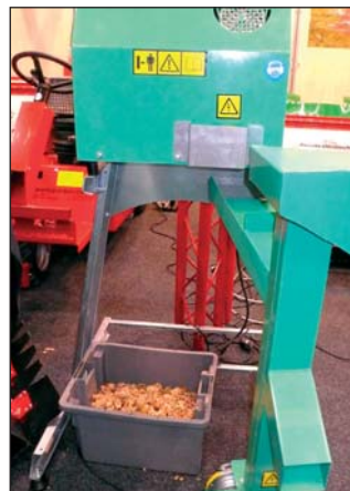
▲ Kíméletes munkát végez a diótörő berendezés
