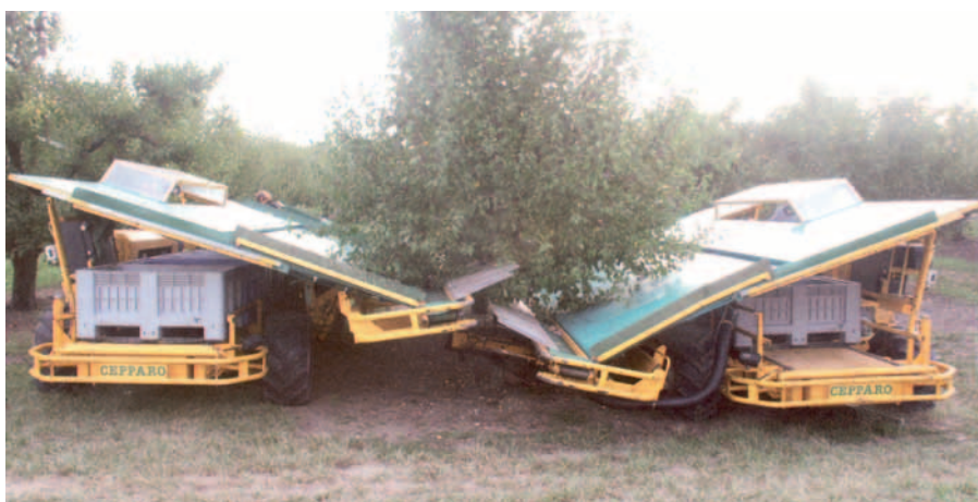
10. kép Önjáró, folyamatos üzemű rázó gép, tartályládákkal (francia)
