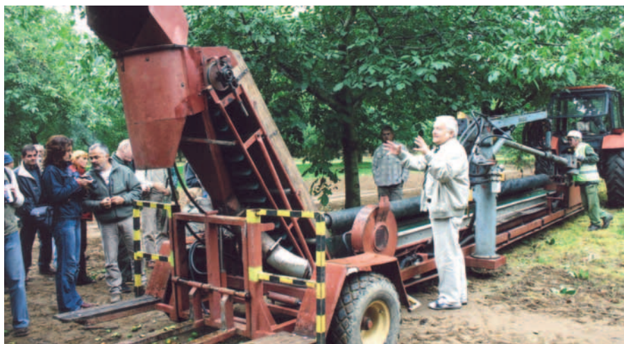
3. kép A hazánkban legelterjedtebben használt törzsrázó gép (dán). A gép mellett a cikk szerzője, dr. Andor Domokos magyaráz
