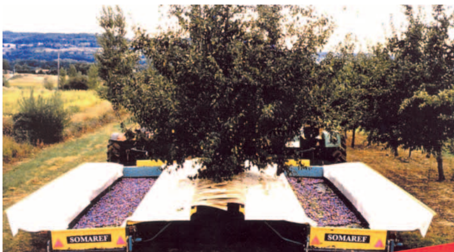
11. kép Folyamatos betakarító gép, önküiritő gyűjtőtartállyal
