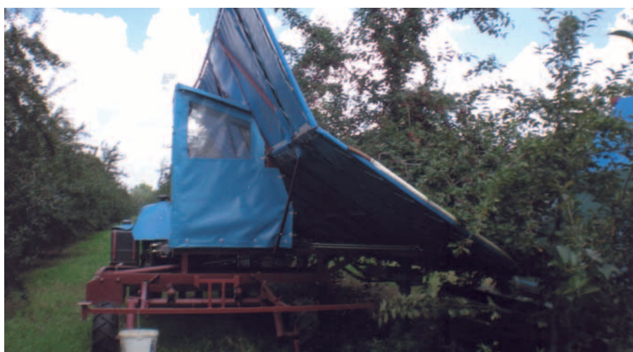
7. kép Önjáró rázó gép rázóegysége (német)
