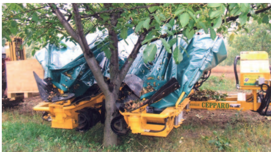
5. kép Vontatott, hidraulikus mozgatású gyűjtőernyővel szerelt gép (francia)
