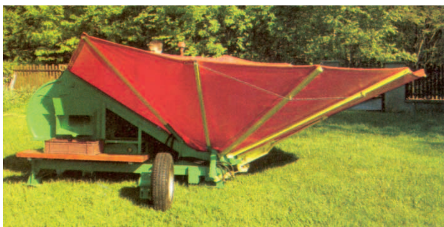
8. kép Vontatott betakarító gép, intenzív ültetvényekhez (szerb)
