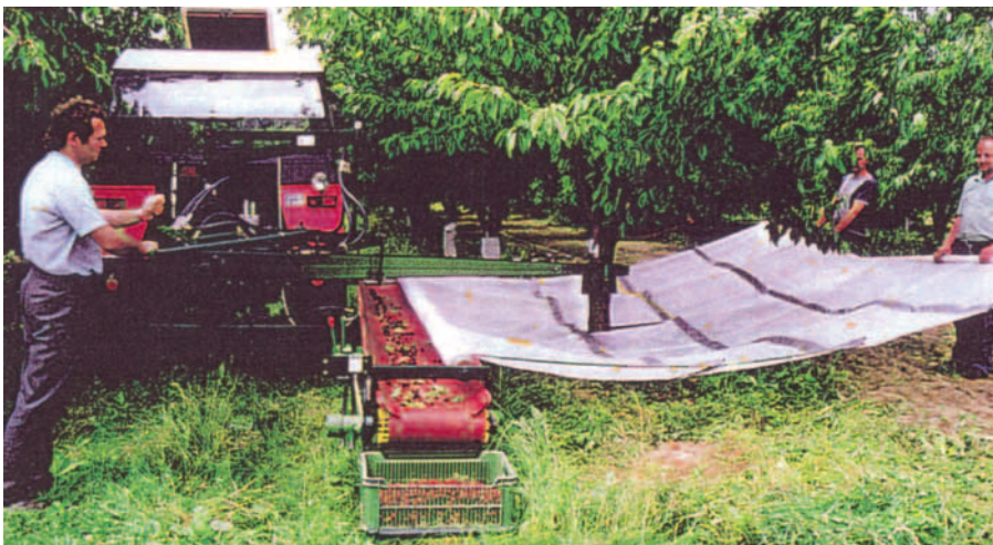
2. kép Traktorra szerelt betakarító gép (cseh)
