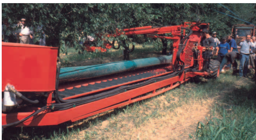
4. kép Idős fák rázására is alkalmas vontatott betakarító gép (német)
