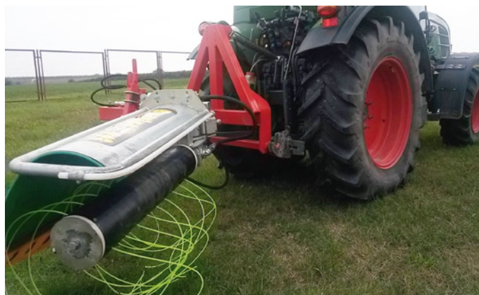
A Battistotti fejegysége: a rotoron 8 helyen lehet a műanyag szálakat felfűzni
