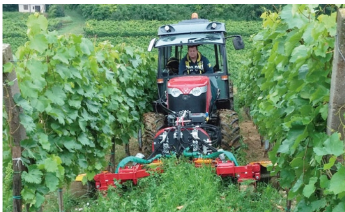
A Fischer Twister gépen a vízszintes rotoron gumiszálak és műanyag szálak vegyesen helyezkednek el
